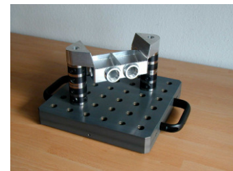
Beispiel DMU 60 Mono Wechselpalette: störungsfreie Bearbeitung aller 6 Seiten, ohne Referenzverlust in 2 Aufspannungen über zwei Hilfsflaschen und Referenzsenkungen Foto: Simantke Renn Tuning
