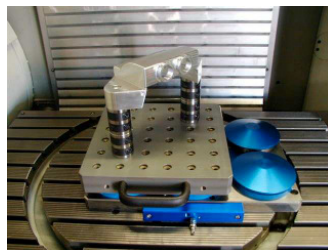
Beispiel DMU 60 Mono Wechselpalette: störungsfreie Bearbeitung aller 6 Seiten, ohne Referenzverlust in 2 Aufspannungen über zwei Hilfsflaschen und Referenzsenkungen Foto: Simantke Renn Tuning
